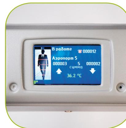
Все рабочие показатели металлодетектора, включая температуру тела посетителя, отображаются на одном дисплее прибора: это максимально удобно, так как функции досмотра и термометрии интегрированы, что исключает человеческий фактор. Автоматизация процесса измерения температуры освободит от этих обязанностей сотрудников охраны и повысит уровень качества выполнения главной задачи — досмотра на предмет проноса запрещенных металлических предметов.
