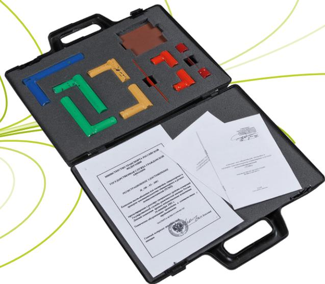
Наша компания при определении обнаружительной способности металлодетектора пользуется понятием «уровень безопасности», который определяется при помощи комплекта тест-объектов ФГИМ 41 1449 004 СБ.
